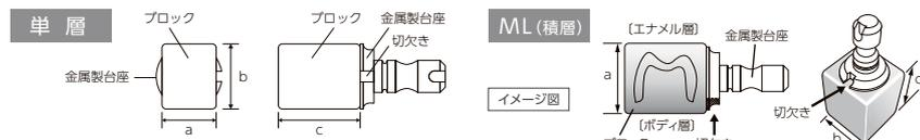
※ML(マルチレイヤー)は金属製台座の切欠き側がボディ層、反対側がエナメル層です。CAMソフトの仕様により、エナメル層とボディ層が逆方向に加工される可能性があります。加工前にCAMソフト取り扱いメーカーにご確認ください。
