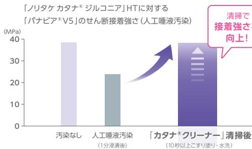
測定条件: 被着面: #1000 研磨面をサンドブラスト処理、被着面積φ5mm、37℃水中保管1日後測定
