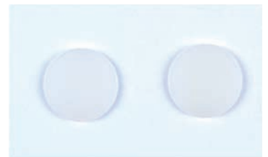
水中での浸漬試験前(左)後(右)
