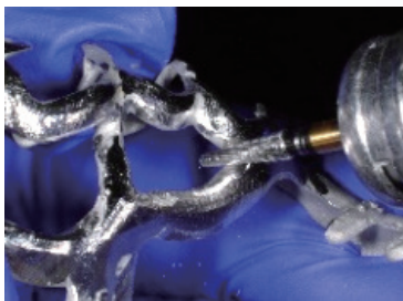
図⑦ クラスプとコネクタとの隙間の比較的細かい部分の調整 (H138SHAX-023)
