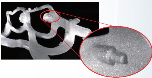
図④ このケースでは、術者のケアレスミスで内面のサポートバーを残したままプリント出力および鋳造をしてしまった。
