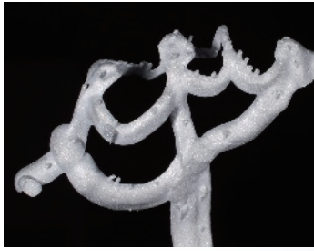
図①・図② 3Dプリンターで出力された義歯フレームパターンを鋳造し、スプレーカットをした状態。鋳造体表面にサポートバー痕が観察できる
