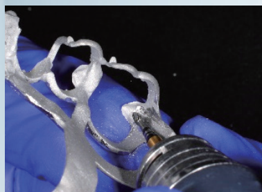
図⑤・図⑥ クラスプ内面のサポートバーや気泡などの除去 (H73SHAX-014: 図⑤、H139SHAX-023: 図⑥)
