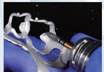
図⑤・図⑥ クラスプ内面のサポートバーや気泡などの除去 (H73SHAX-014: 図⑤、H139SHAX-023: 図⑥)
