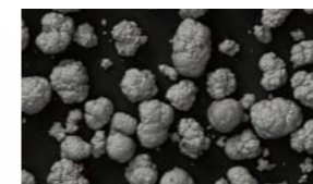
FLASH pearl(炭酸カルシウム) 平均粒子径54μm SEM画像(×150)
