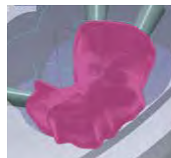
スーパーファインモード加工サイクル内面 全領域を0.6mmツールで細密加工するため、 良好な適合が得られる
